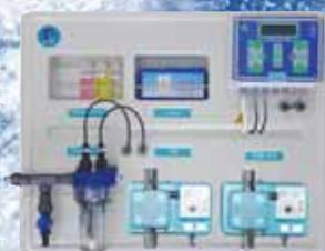
**БЛОК УПРАВЛЕНИЯ БАССЕЙНОМ** (автоматический регулятор рН-редокс). В комплекте с электродами, сварочным кабелем, идущим к электроду, проточным электролизёром, встроенным сетчатым фильтром и буферами. Всё собрано на 60 x 75 см. пластиковой панели. На панели указаны инструкции по эксплуатации и зарезервировано место для монтажа дозирующего насоса. Дозировочные насосы не подсоединены.
