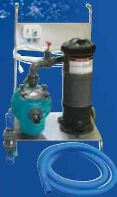
**Компактный пылесос.** Собран на колесе защитного контейнера, колесо произведено из нержавеющей стали, в комплект входят картриджный фильтр, монофазный самовсасывающий насос, ручной пылесос Poolvac, шланг, телескопическая штанга и обратный клапан. Предохранитель и 18 м. кабель в комплекте. Для бассейнов без впускного отверстия. Может быть использован в качестве блока фильтрации.
